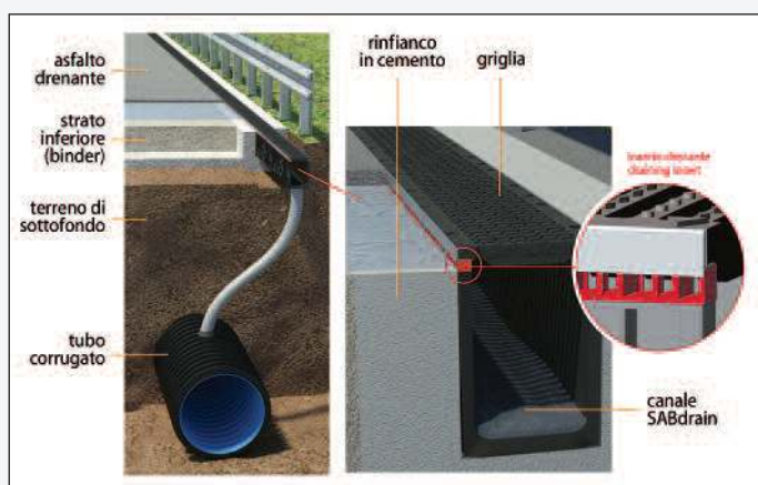
Figura 1 - La canaletta con inserto laterale per asfalti drenanti
