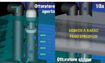
10a, 10b. Funzionamento e schematizzazione del cilindro della cisterna con galleggiante-trappola per gli oli sversati
