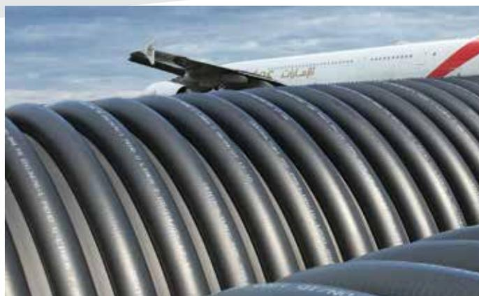
Tubazione spiralata composita in PE e acciaio, costituita da una superficie interna di PE liscia, intorno alla quale viene posizionato un profilo di irrigidimento in acciaio a spirale e ricoperto da un secondo strato di PE. La tubazione SGS, realizzata in medi/grandi diametri, nasce principalmente per la costruzione di:
