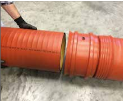
- posizionamento verso l'alto dell'apparato di collaudo TWICE del bicchiere - imbocco maschio nel bicchiere
